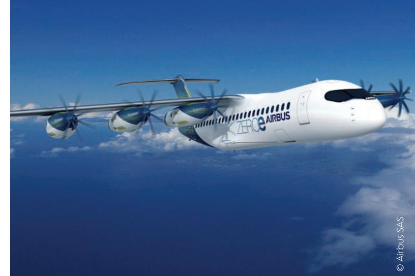
Le futur court-courrier « zéro émission » d'Airbus pourrait être équipé de six nacelles à hydrogène, un bloc associant réservoir, pile, moteur et hélice.
