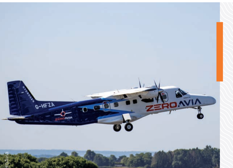
L'avion d'essai de ZeroAvia. L'un de ses moteurs est électrique et alimenté par une pile à hydrogène.
